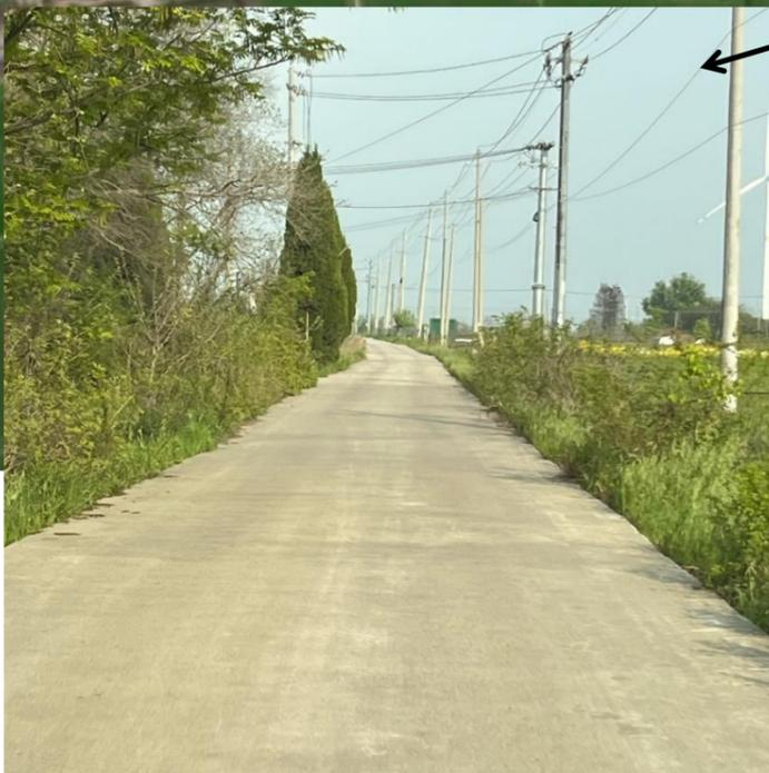
10、道路有很长一段在与农田连接处高差较大，存在安全隐患，需安装警示桩，道路两边长度各约180米；
