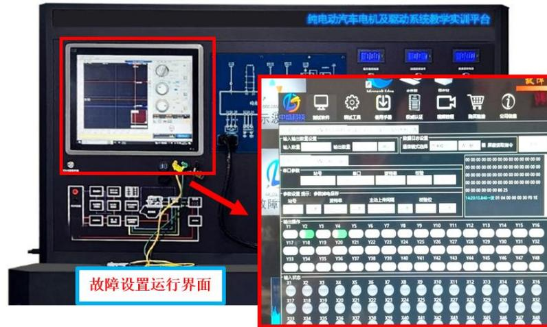
★6. 软件采样及教学仿真计算机：17寸电容触摸屏一体机工业控制机，Intel/Celeron 双核 1.8G，win8 系统，集成示波器功能，信号波形采样速率：50MHz。附本实训平台 17寸仿真计算机电机驱动波形测量示波器运行界面图片。
