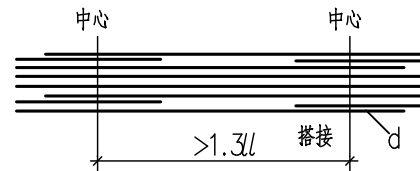
图2a. 受力钢筋搭接接头面积百分率25%
